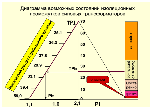
Рис.4. Диаграмма возможных состояний изоляционных промежутков силовых трансформаторов
