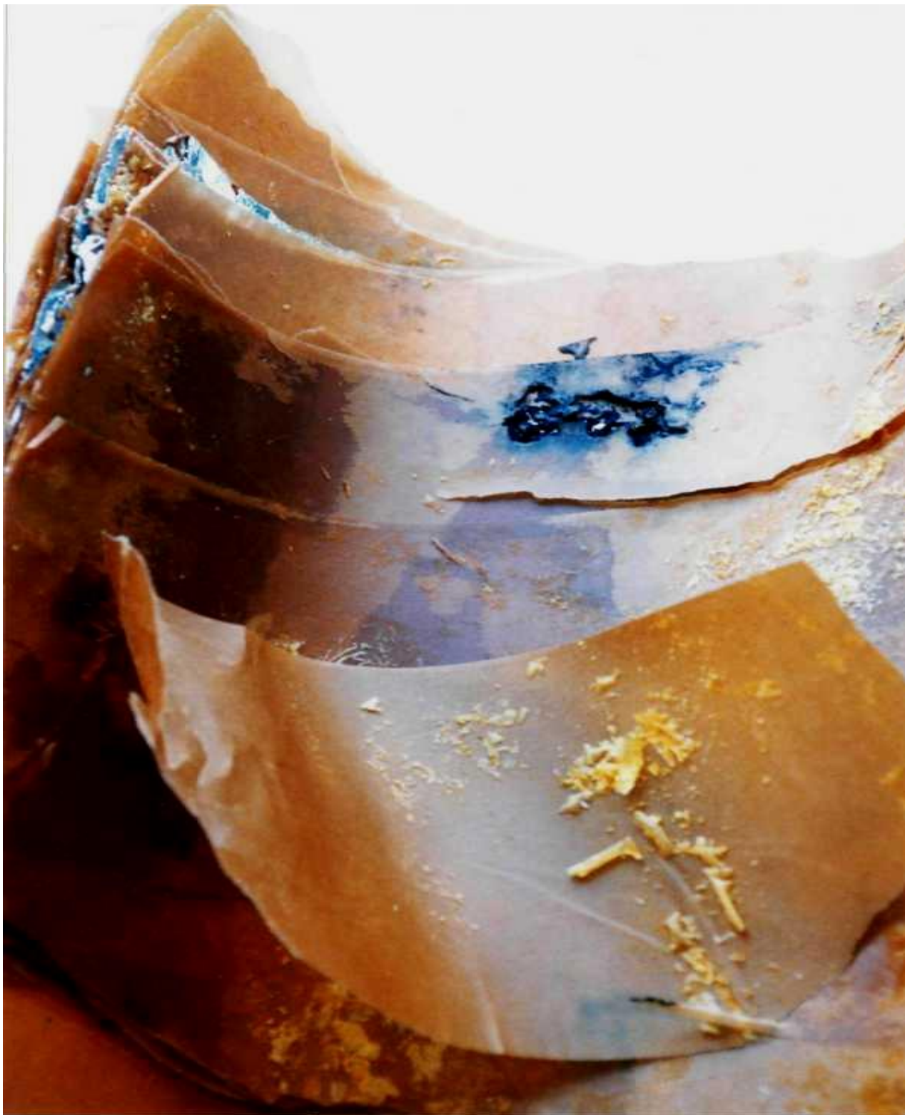
Рис. 1. Отложение X-воска между слоями бумажной основы и очаг развития пробоя во вводе 220 кВ.
